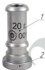
Рисунок 3 - Устройство для определения времени и степени высыхания Константа СВ20 (груз массой 20 г)
