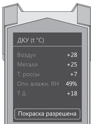
Проведение измерений преобразователем ДКУ
