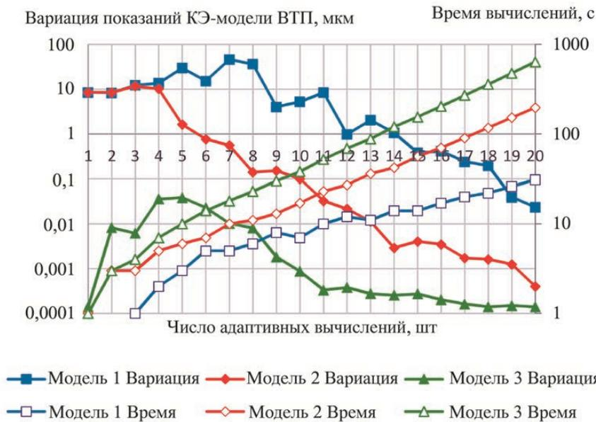
**Рис. 9. Зависимость вариации показаний КЭ-модели ВТП и времени вычислений от числа адаптивных вычислений**
