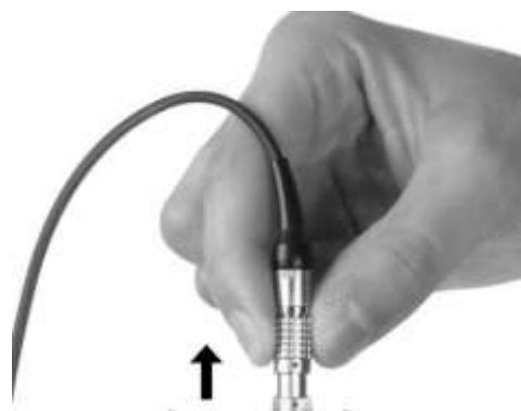
Рисунок 1.2 Отсоединение преобразователя от БОИ
