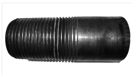
Рис. 2 — Фотография трубы с резьбой \varnothing 88 \times 123 , бывшей в употреблении
