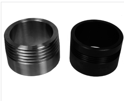
Рис. 10 – Контрольные образцы дефектов резьбы, а) – КО-90Н-4Т-3, б) – КО-102Н-В13-3
