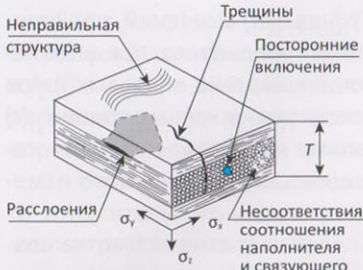
Рис. 1. Основные дефекты в изделиях из углепластиков
