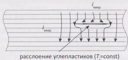
Рис. 3. Картина вихревых токов, при которой возможно выявление расслоений
