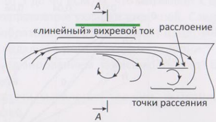
Рис. 8. Картина распределения вихревых токов в плоскости обмоток
