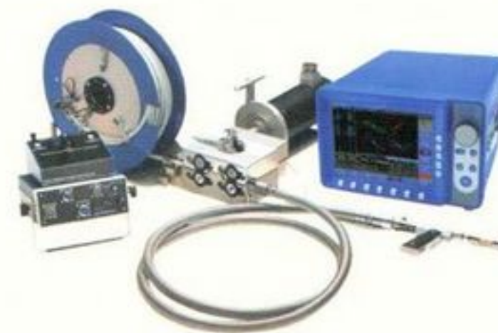
Рис. 9. Комплект прибора MIZ-28 для контроля труб теплообменников
