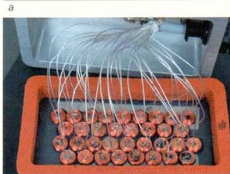
Рис. 3. Один из вариантов коммутации обмоток первичных преобразователей многоэлементных преобразователей в процессе контроля (а) и устройство многоэлементного преобразователя (б)
