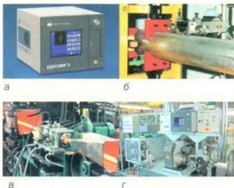
Рис. 11. Вихретоковый дефектоскоп EDDYCHECK 5 (а) и встроенные в поточные линии преобразователи для контроля труб (б), раскаленных прутков (в) и проволоки (г)
