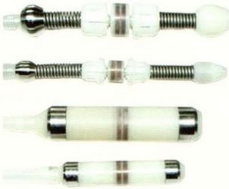
Рис. 8. Один из вариантов исполнения внутритрубных преобразователей
