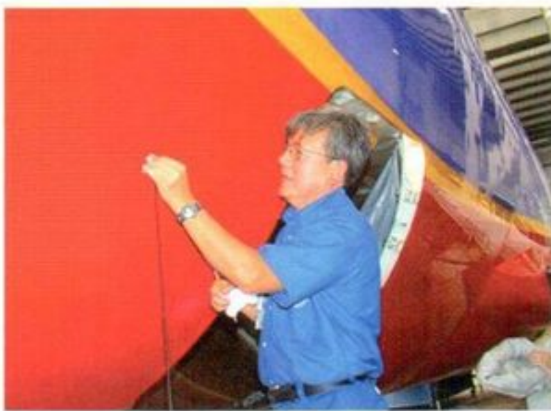
Рис. 2. Контроль обшивки планера самолета с целью выявления мест коррозии
