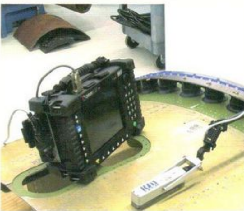
Рис. 12. Система контроля цилиндрических поверхностей автоматизированным двухкоординатным сканером
