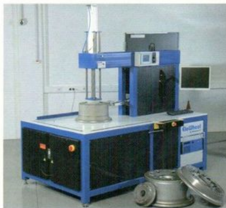
Рис. 13. Система контроля дисков на базе трехкоординатной системы позиционирования
