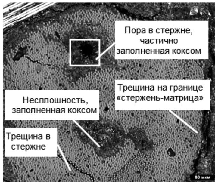
*Рис. 1. Вид дефектов на поперечном шлифе стержня УУКМ (X200) [5]*
