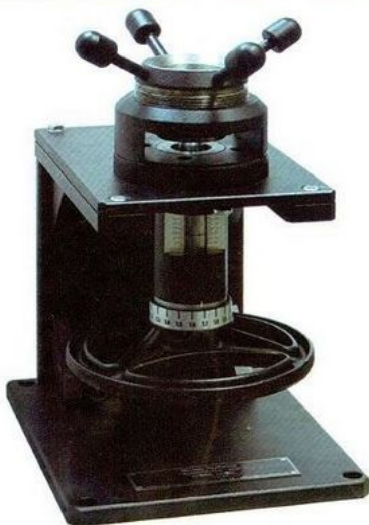
Рис. 7. Штмп (пресс) Эриксона для контроля прочности при выдавливании
