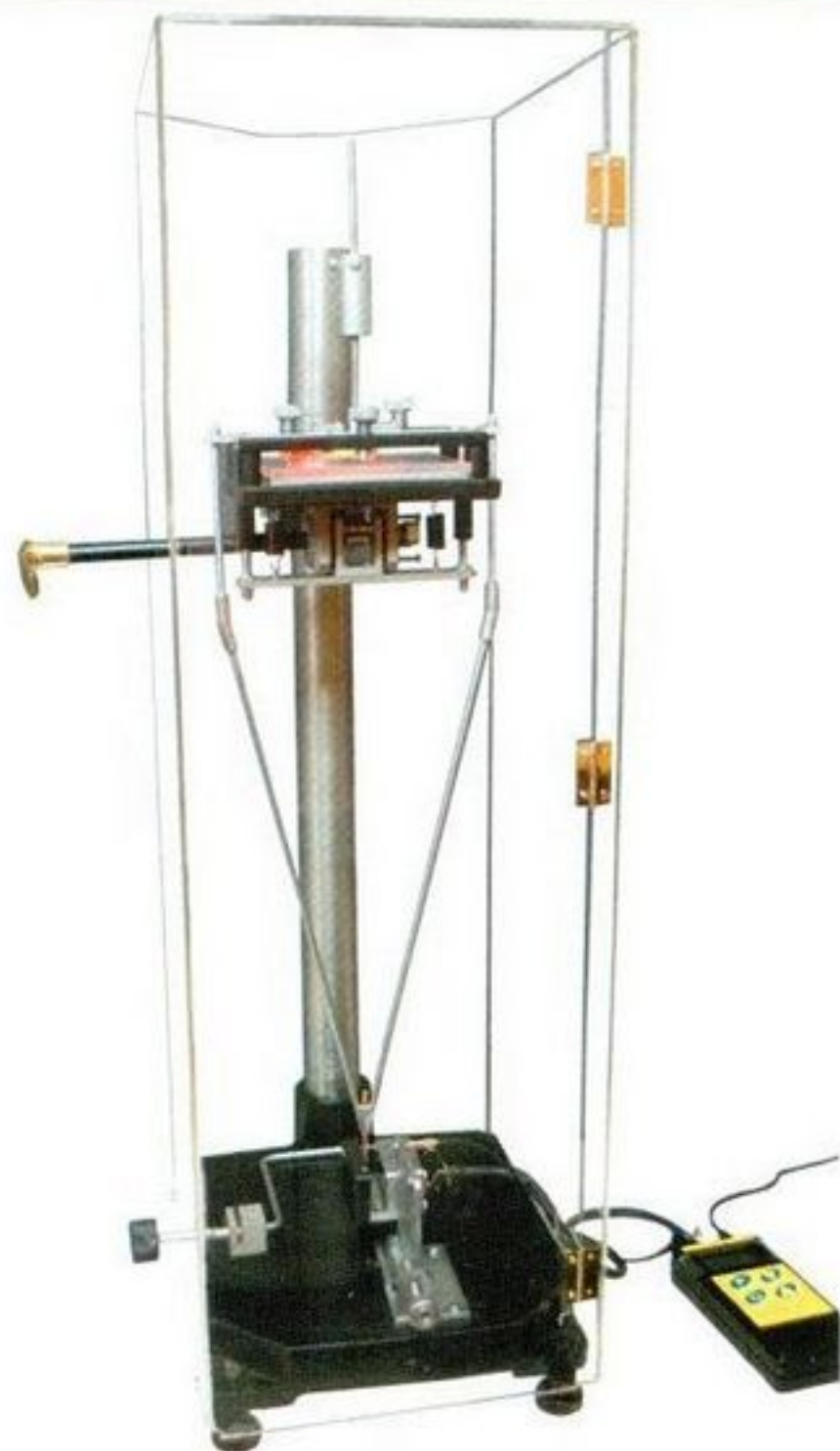
Рис. 8. Маятниковый твердомер «Константа-МТ1» для определения твердости
