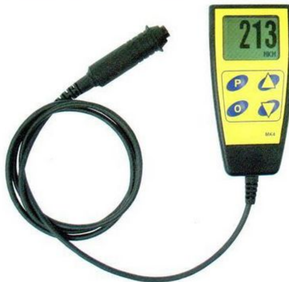
Рис. 2. Толщиномер защитных покрытий «Константа МК4»
