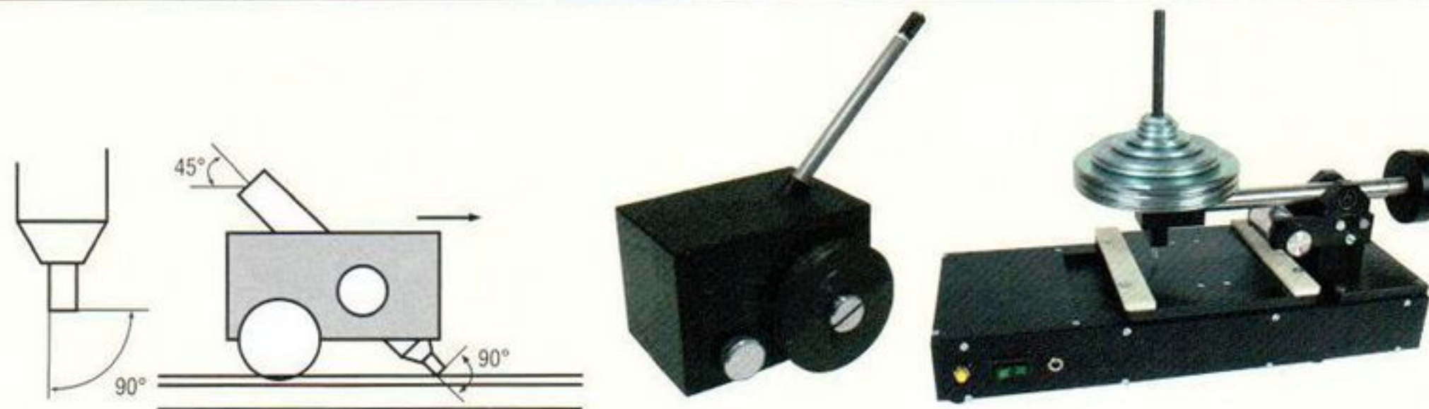
Рис. 9. Приборы для определения твердости царапанием
