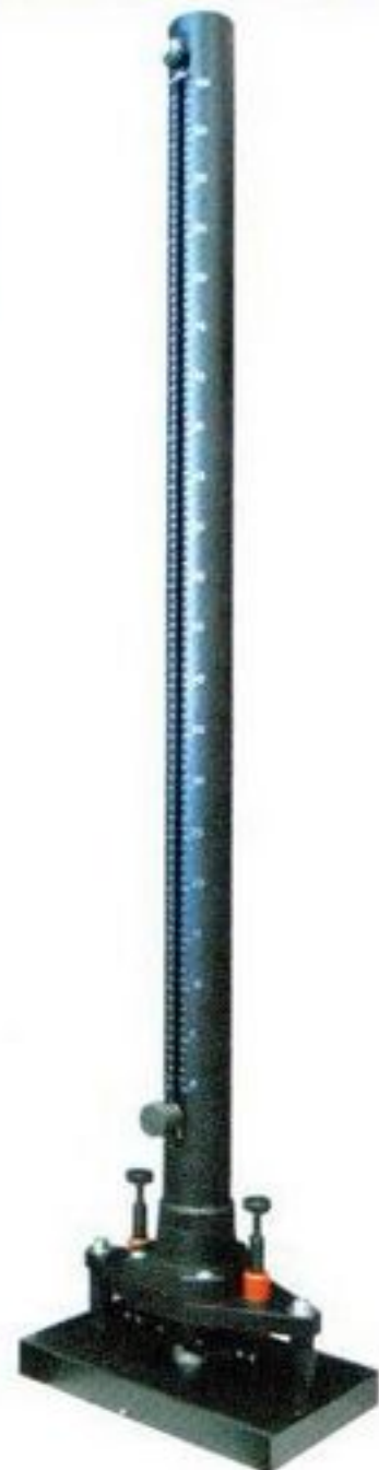
Рис. 5. Прибор для контроля прочности при ударе «Константа У2»
