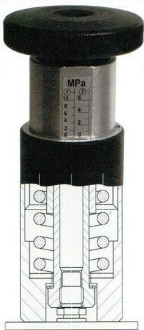
Рис. 4. Механический датчик-адгезиметр «Константа АЦ»
