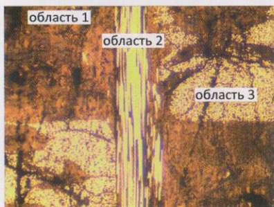
Рис. 6. Снимок областей, в которые проводилось индентирование. Область 1 — матрица (пек), область 2 — продольный срез стержня, область 3 — торцовый срез стержня.
