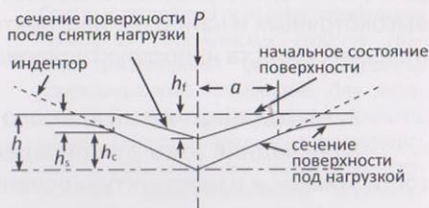
Рис. 1. Схематическое изображение поперечного сечения процесса индентирования, где h_c — контактная глубина, h_s — деформация поверхности по периметру контакта, h — глубина при максимальной нагрузке, h_f — финальная глубина отпечатка, P — сила, прикладываемая к индентору
