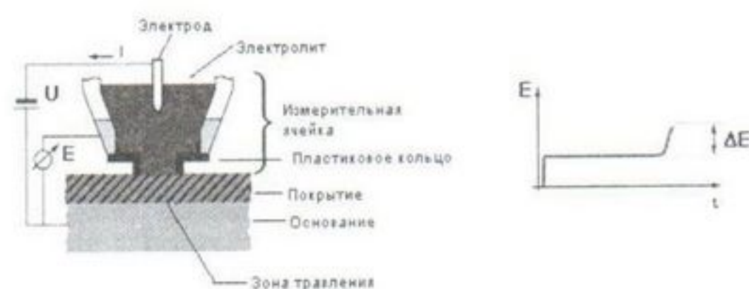
Рис. 1. Схематическое представление кулонометрического метода измерения и изменения потенциала.
