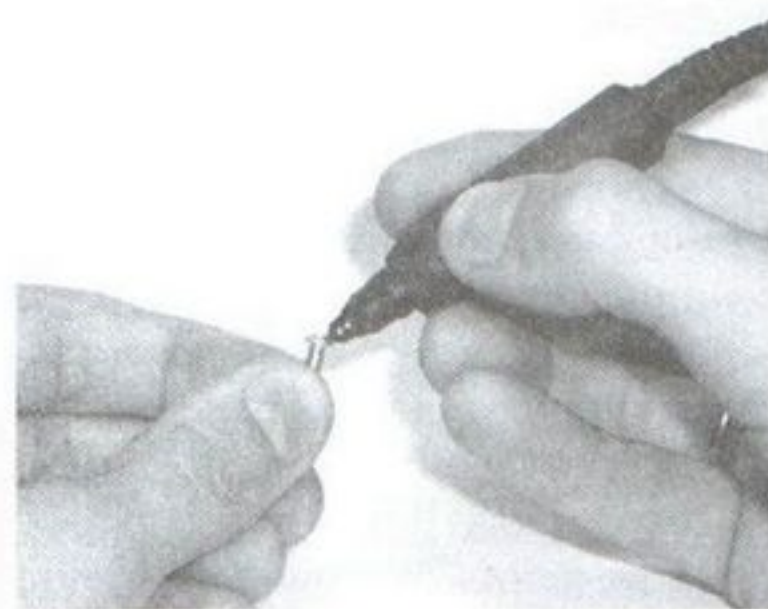
Рис. 10. Применение вихретокового фазового преобразователя для измерения толщины гальванических покрытий на крепеже.
