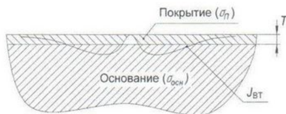
Рис. 7. Распространение вихревых токов в электропроводном неферромагнитном покрытии и электропроводном неферромагнитном основании.
