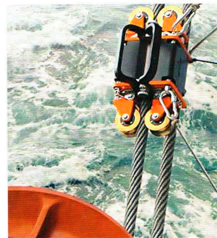
Рис. 16. Контроль канатов с помощью технологии MFL дефектоскопом Интрос-авто
