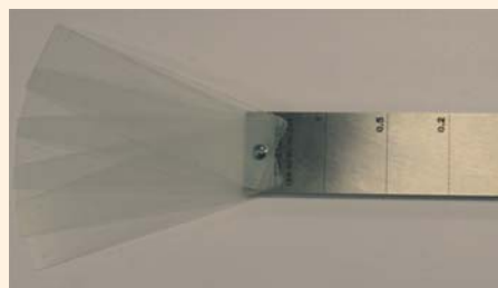
Рис. 4. Внешний вид стандартного образца СО-210.01 с образцами толщины неэлектропроводящего покрытия
