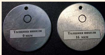
Рис. 1. Внешний вид меры толщины покрытия никель/сталь20
