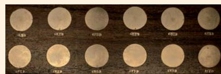
Рис. 2. Внешний вид комплекта мер удельной электропроводности ГСО №№ 3447 ÷ 3458-89П (сплавы на основе титана)
