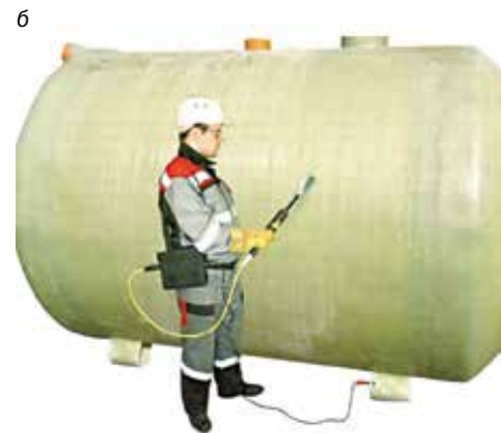
Рис. 6. Электроискровой метод НК: а — принцип действия; б — проведение контроля
