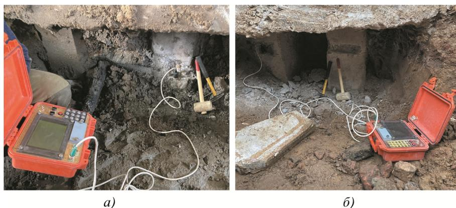
Рис. 1. Проведение полевых испытаний свай на первом (а) и втором (б) объектах
